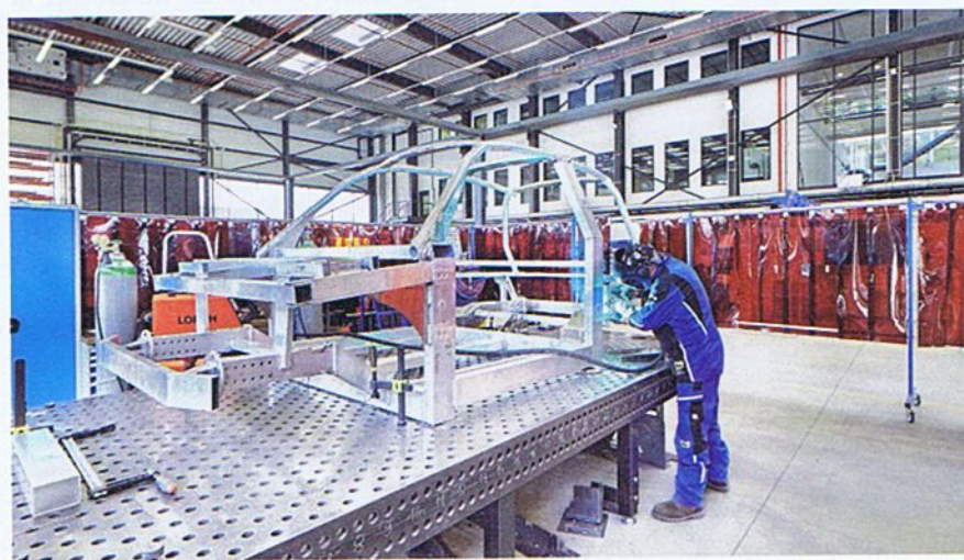
Ein geschweißter Rahmen aus großen Aluminiumprofilen bildet den Kern des Kleinfahrzeugs.
