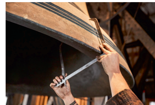
Die „Schlagringdicke“ (links) hilft, zusammen mit anderen Maßen, die Glocke im Computer zu simulieren. Unten: Im Kölner Glockenstuhl arbeiten die Forscher Hand in Hand.
