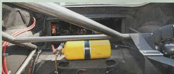
Die Löschanlage lässt sich von innen und von außen aktivieren. Zusätzlich ist ein Zwei-Kilo-Handfeuerlöscher Pflicht
