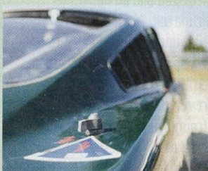
Der Hauptschalter hinten rechts klemmt die Batterie ab
