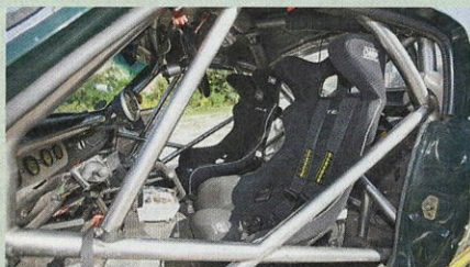
Überrollkäfig, Rennsitze und Sechspunktgurte erhöhen die Überlebenschancen bei Unfällen
