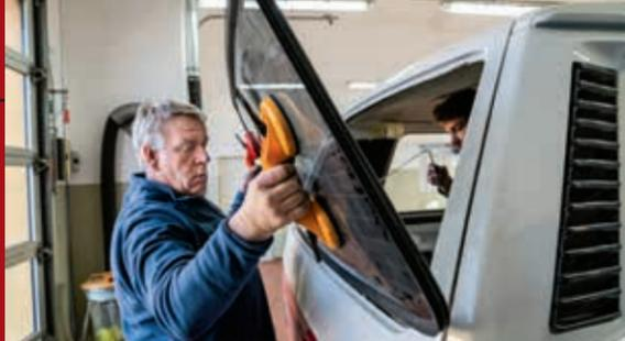
▲ Die Heckscheibe wird mit neuer Dichtung eingesetzt
