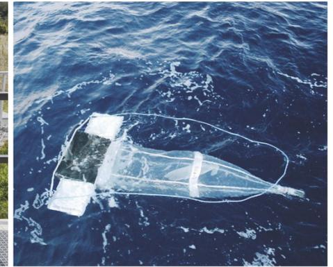
**Links: Biologische Reinigungsanlagen wie diese in Hamburg filtern Mikroplastikteilchen aus dem Straßenabwasser. Rechts: »Manta-Netze« sammeln winzige Plastikteilchen. Anhand der Proben können Forscher die Verschmutzung der Meere nachvollziehen.**
