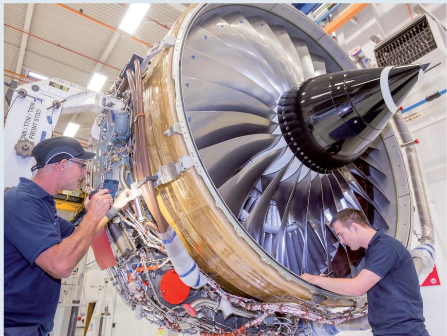
Montage bei Rolls-Royce eines Turbofan-Strahltriebwerks vom Typ Trent 700, wie sie beim Airbus A330 zum Einsatz kommen. (Foto: Rolls Royce)
