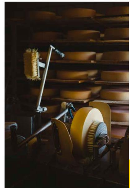
**Mit der Käseschmiermaschine werden die Laibe gebürstet und mit Salz eingerieben.**
