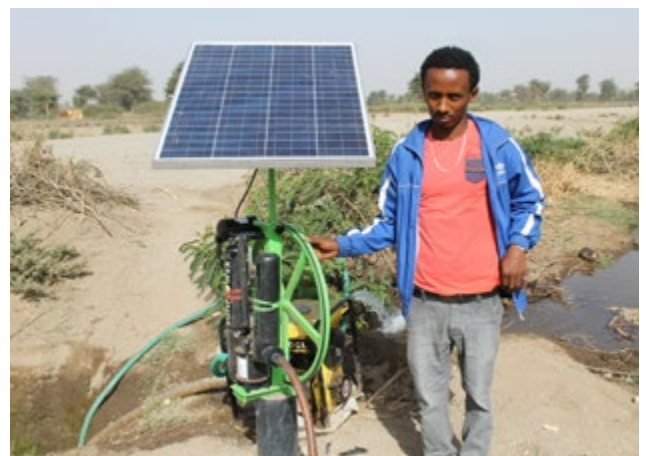
Solarbetriebene Wasserpumpe: Grundwasser nachhaltig zu nutzen ist insbesondere für die Trockenzonen der Welt überlebenswichtig. Foto: Tadesse Desalegne, IWMI
