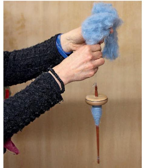
*/ Die frei hängende Spindel dreht sich um ihre Achse bis ein Faden entsteht, der am Schaft aufgewickelt wird.*
