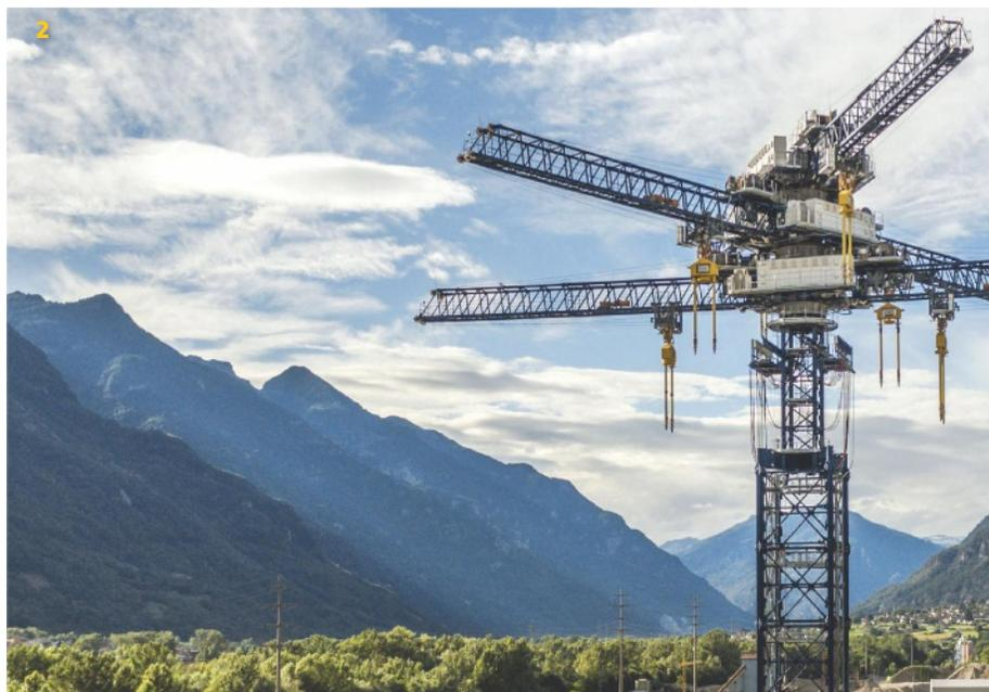
**1** Die Schweizer Pilotanlage Energy Vault speichert mithilfe von Gewichten Energie. **2** Ein Kran zieht dazu die schweren Quader in die Höhe. Beim Herunterlassen wird die Energie wieder frei: Eine Seilwinde treibt einen Generator an
