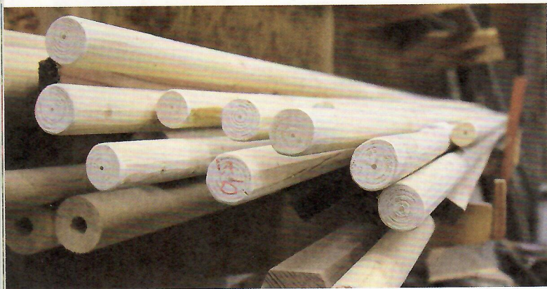
Die Stocherstangen werden komplett aus einem Fichtenstamm gemacht. Für jeden Bootsführer in Länge und Dicke eine individuelle Stake.
