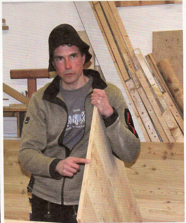
Zimmerermeister Rudolf Raidt nutzt für den Bootsbau Dreischichtplatten aus heimischem, widerstandsfähigem Lärchenholz.
