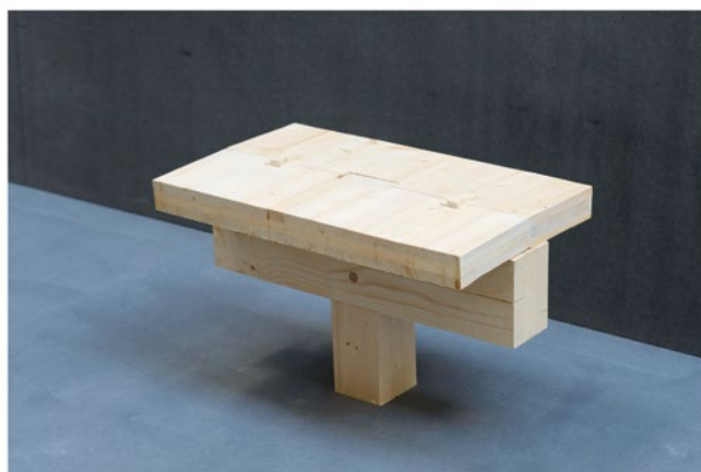
Auch die Buchenholzdübel ermöglichen ein stahlfreies Bausystem.
