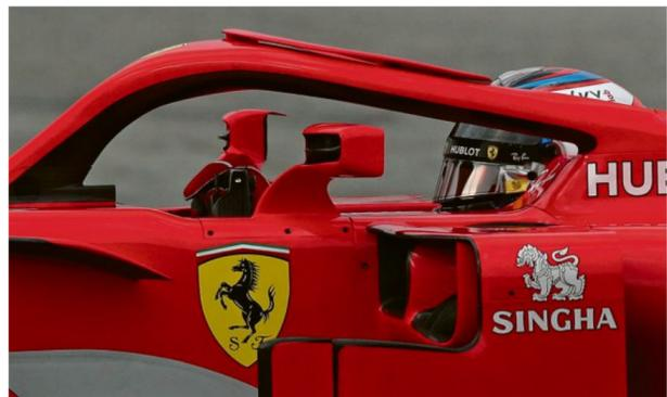
Fühlt sich an wie Fahren mit Dach: Ferrari mit Halo über dem Cockpit
