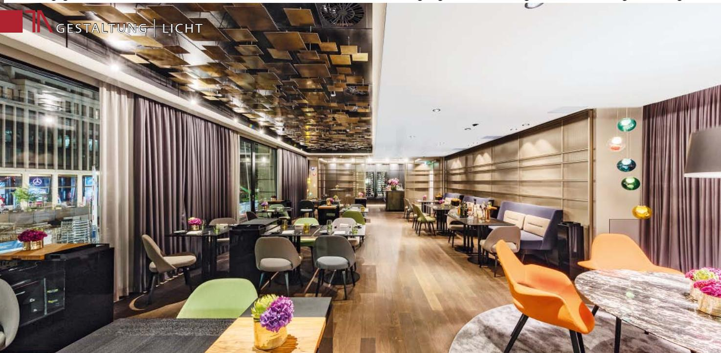
**Restaurant.** Die Grundbeleuchtung ist hier insgesamt gedämpft gehalten, Deckeneinbau-Downlights bringen aber genügend Licht auf die Tische. Für die Aufnahme der Deckenleuchte in die sehr empfindliche Akustikdecke (Baswa-Material) mussten Formelemente mit gesetzten Bohrungen in die Unterkonstruktion eingebracht werden.
