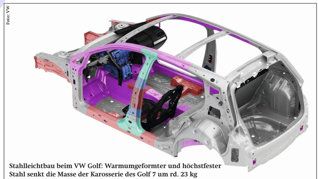
Stahlleichtbau beim VW Golf: Warmumgeformter und höchstfester Stahl senkt die Masse der Karosserie des Golf 7 um rd. 23 kg
