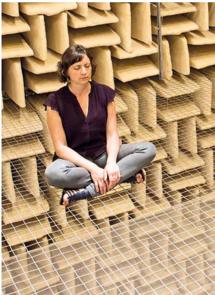
**HINHÖREN** Im Fraunhofer Institut in Stuttgart sitzt die Autorin zum ersten Mal in ihrem Leben in einem schalltoten Raum. In der Mitte der Kammer ist ein durchsichtiges Gitter gespannt, das als Fußboden dient. Zuerst lenkt das Wandmuster ab, es flirrt und scheint sich zu bewegen. Doch mit geschlossenen Augen gelingt es, auf die Geräusche der Stille zu hören, zum Beispiel das Rauschen des eigenen Blutes
