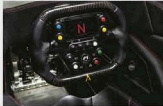
Das Lenkrad des Mono wird von BAC-Partnern bestückt und getestet. Die Kunststoff-Griffstücke unter dem Leder werden für jede Kundenhand individuell im 3D-Druck gefertigt
