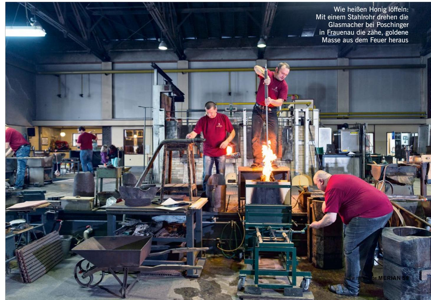
Wie heißen Honig löffeln: Mit einem Stahlrohr drehen die Glasmacher bei Poschinger in Frauenau die zähe, goldene Masse aus dem Feuer heraus
