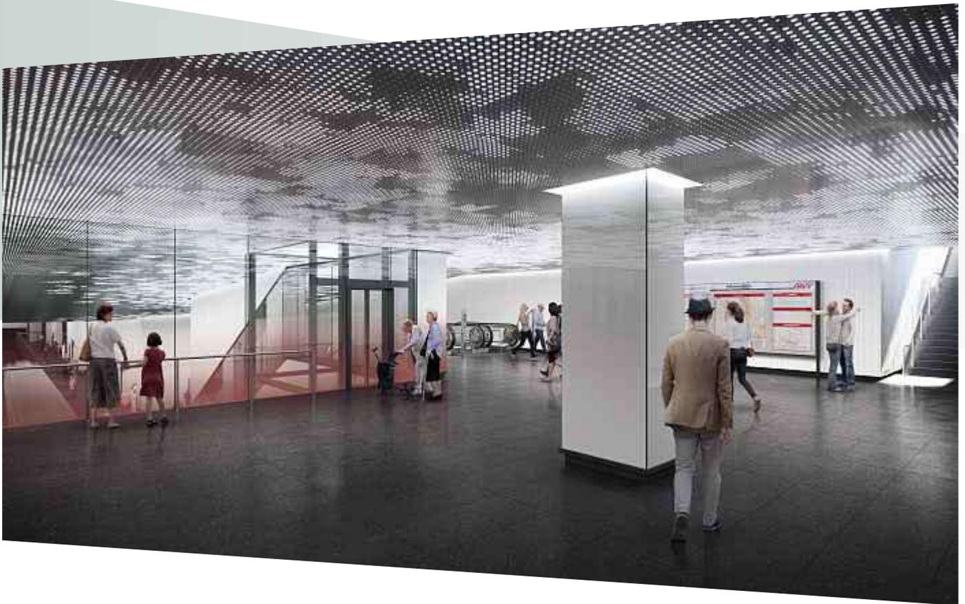
▲ Aufgrund ihrer inhomogenen Perforierung erscheint die raumübergreifende Lochraasterdecke mit integrierten Leuchten wie ein abstrahiertes Blätterdach. In den Randbereichen der Schalterhalle soll die aus der Decke kommende Grundbeleuchtung um Lichtvouten ergänzt werden. Die Farbtemperatur des Lichts variiert in allen öffentlichen Bereichen in Anlehnung an den Tageslicht- und Jahreszeitenverlauf.
