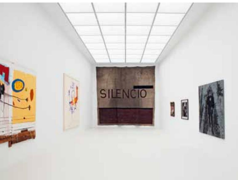
**Wie am Tag.** Diffuses Licht aus Kunstlichtdecken mit einer Farbtemperatur von 4.000 K übernimmt eine absolut homogene, tageslichtähnliche Ausleuchtung der fensterlosen Räume im historischen Bestandsbau Hôtel de Montfaucon.
