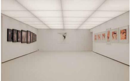
Abb.: Im Untergeschoss übernimmt diffuses Licht aus Kunstlichtdecken eine tageslichtähnliche Ausleuchtung der Räume.
