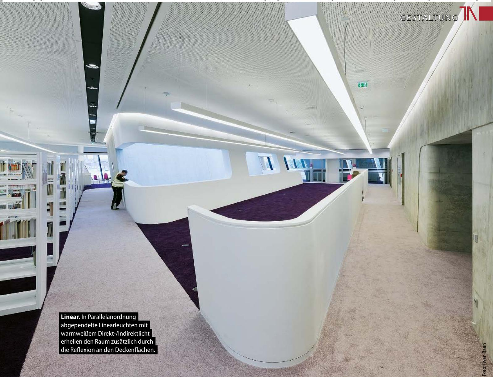
**Linear.** In Parallelanordnung abgependelte Linearleuchten mit warmweißem Direkt-/Indirektlicht erhellen den Raum zusätzlich durch die Reflexion an den Deckenflächen.
