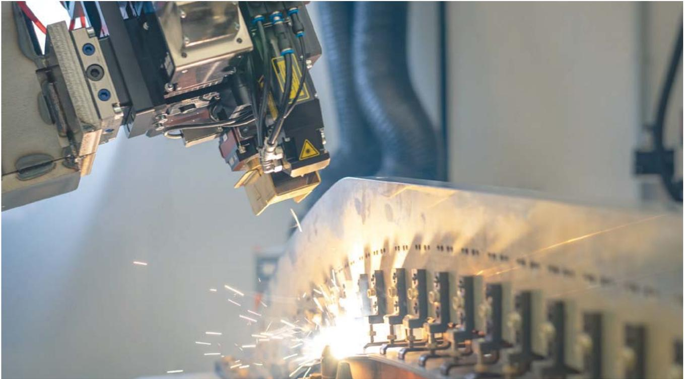
► Nicht nur im Karosseriebau hat sich beim Laserschweißen die Inline-Prozessüberwachung bewährt, die manche Hersteller bereits in die Bearbeitungsköpfe integrieren
