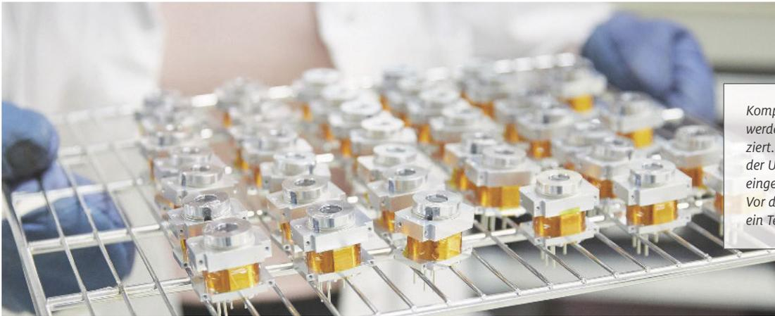
Komponenten für Atomuhren werden in großer Zahl produziert. Das Rubidium als Herz der Uhr wird in eine Glasröhre eingeschweißt (unten links). Vor dem Einsatz im All steht ein Test im Vakuum (rechts).
