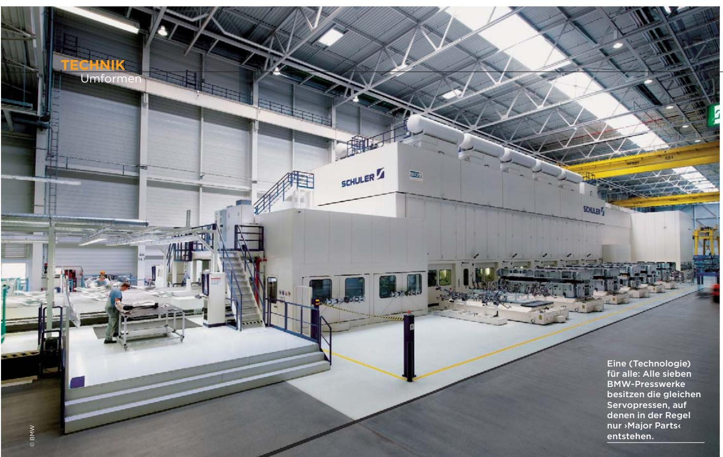
Eine (Technologie) für alle: Alle sieben BMW-Presswerke besitzen die gleichen Servopressen, auf denen in der Regel nur ›Major Parts‹ entstehen.
