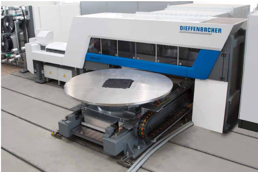
Das Fiberforge-Verfahren ermöglicht es, Tapes zu einer endkonturnahen Geometrie zu legen.
