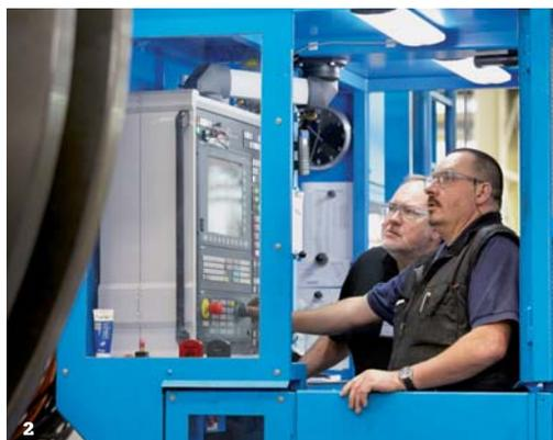
**1** Die Anforderungen für das Retrofitting der ›Wotan Rapid 6‹ waren hoch, da die Bauteile sehr genau bearbeitet werden müssen. Die maximale Abweichung über die gesamte Länge von 10 Metern in der X-Achse beträgt 60 µ.
