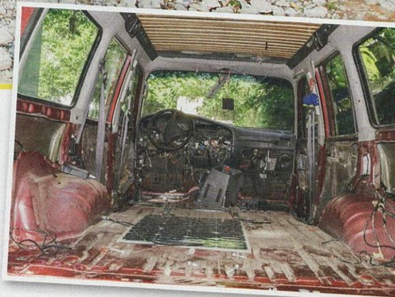
Ausgeräumt: Hier wird nun eine Holzplatte verlegt, auf der die Möbel befestigt werden
