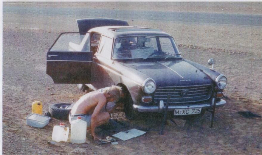
▼ Der Peugeot 404 leidet unter der Sahara: Ausgeschlagene Achslager, ein defekter Anlasser, Getriebeprobleme und platte Winterreifen, um nur das Wesentliche aufzuzählen
