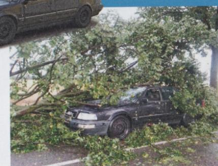
Das Dach wurde dank des Schiebedachkastens nicht lebensbedrohlich eingedrückt. Dennoch ist der Audi V8 ein einziges Trümmerfeld
