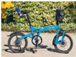
**Das Birdy Speed (ab 2299 Euro) ist mit seiner schnell übersetzten Shimano-Ultegra-9-Gang-Schaltung und den Scheibenbremsen der Sportler unter den Falträdern. Die Vollfederung ermöglicht einen sehr hohen Fahrkomfort**
