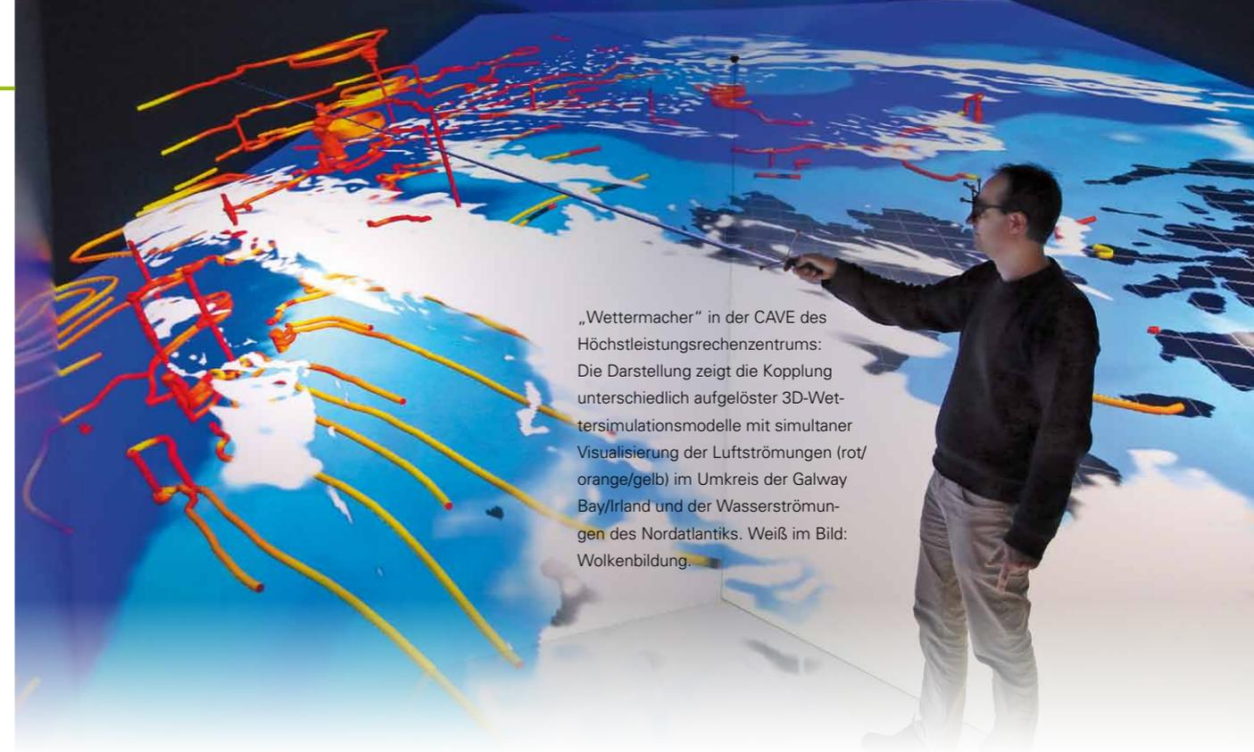
„Wettermacher“ in der CAVE des Höchstleistungsrechenzentrums: Die Darstellung zeigt die Kopplung unterschiedlich aufgelöster 3D-Wettersimulationsmodelle mit simultaner Visualisierung der Luftströmungen (rot/orange/gelb) im Umkreis der Galway Bay/Irland und der Wasserströmungen des Nordatlantiks. Weiß im Bild: Wolkenbildung.
