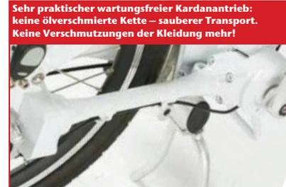
**Sehr praktischer wartungsfreier Kardantrieb: keine överschmierte Kette – sauberer Transport. Keine Verschmutzungen der Kleidung mehr!**
