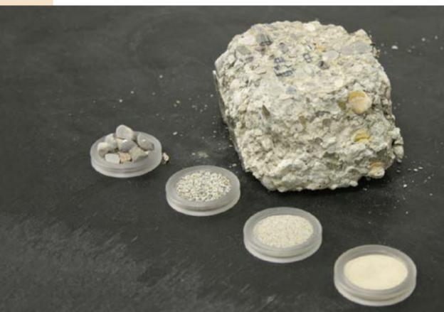
In der elektrodynamischen Fragmentierungsanlage des Fraunhofer-Instituts für Bauphysik verwandeln künstliche Blitze Bauschutt zurück in Sand und Kies.
