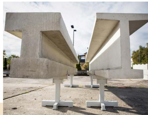
**Mit Carbonbeton lässt sich dünner bauen: bis zu 75 Prozent Materialeinsparung.**
