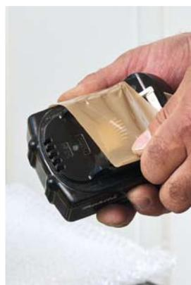
Akkus aus Power-Tools werden abgeklebt und in der gelben Box gesammelt
