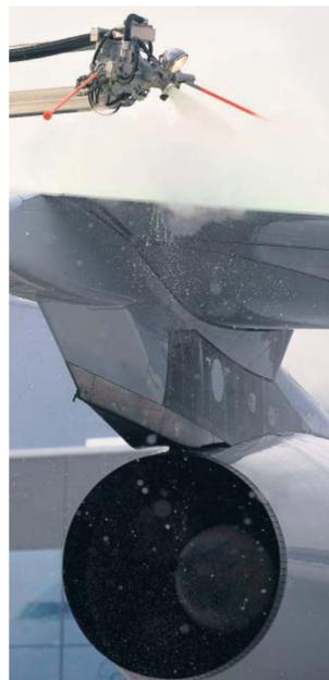
Druckvoll: Der heiße Reinigungsstrahl sprüht mit bis zu zwölf Bar.
