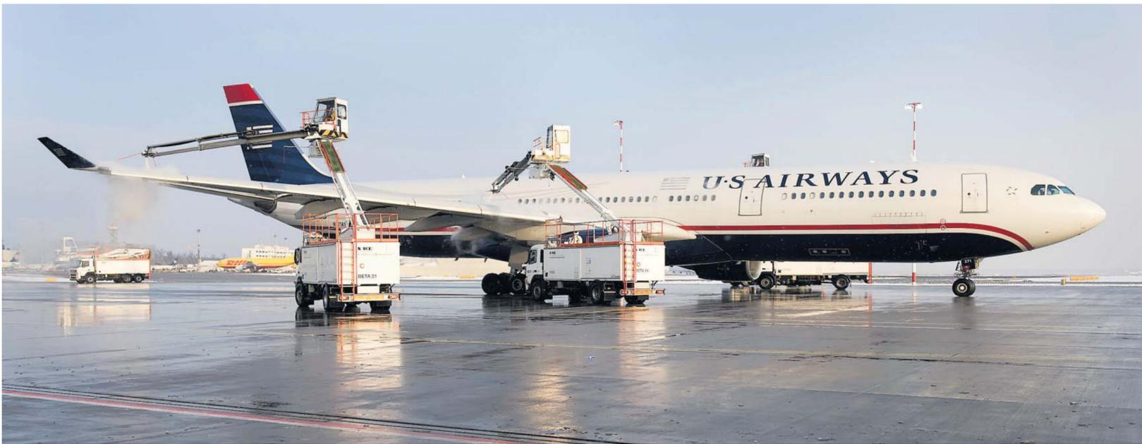
Vom Eise befreit: Auf dem Vorfeld entfernen Spezialfahrzeuge zur Enteisung von Flugzeugen, sogenannte „Betas“, Ablagerungen von den Tragflächen.
