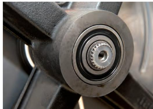
**Waschmaschine, leicht zu reparieren: Das Lager im Metallbottich ist austauschbar**
