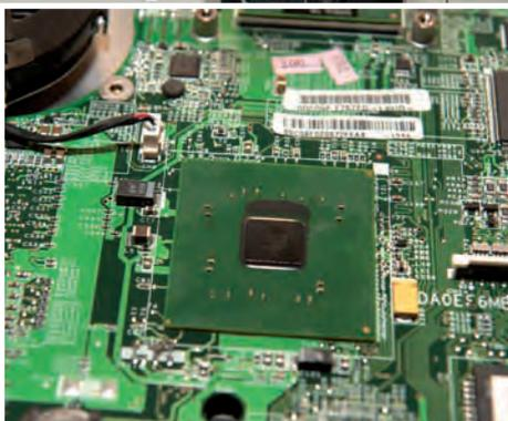
**Laptop: Die Grafikkarte – die grüne Platte mit dem schwarzen Quadrat – ist bei diesem Gerät eingepresst und kann nicht getauscht werden. Ausgetauscht werden müsste die ganze Platine**
