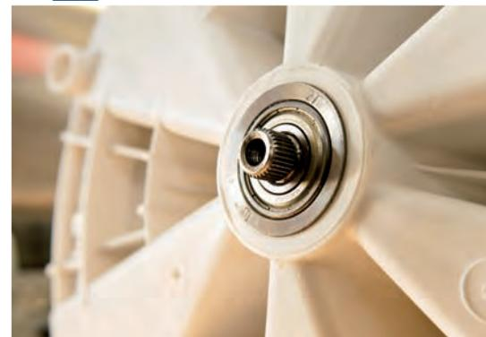
**Waschmaschine, schwer zu reparieren: Ist der Bottich aus Plastik und das Lager eingepresst, kann man das Lager nicht tauschen**
