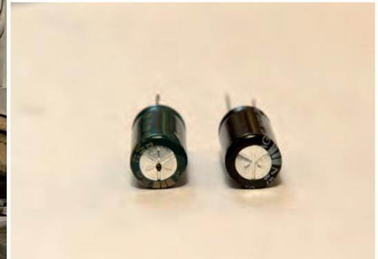
**Elektrolytkondensatoren für Unterhaltungselektronik: Der linke ist zu schwach und bläht sich bei Überwärmung auf, der rechte hält um Jahre länger**
