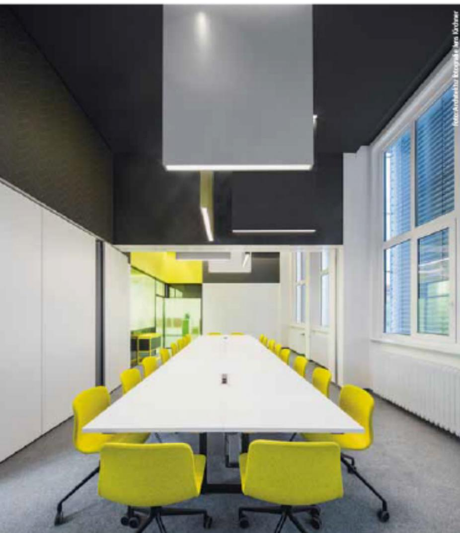
Jeder Konferenzraum wurde mit Absorbern akustisch optimiert. Die schwarze Farbe an der Decke und im oberen Drittel der Wände kaschiert die extreme Raumhöhe. Um die Lichtpunkte auf eine niedrigere Raumhöhe zu bringen, entwickelten die Lichtplaner Scheiben mit leicht zurückversetztem, nach unten strahlenden LED-Profil.
