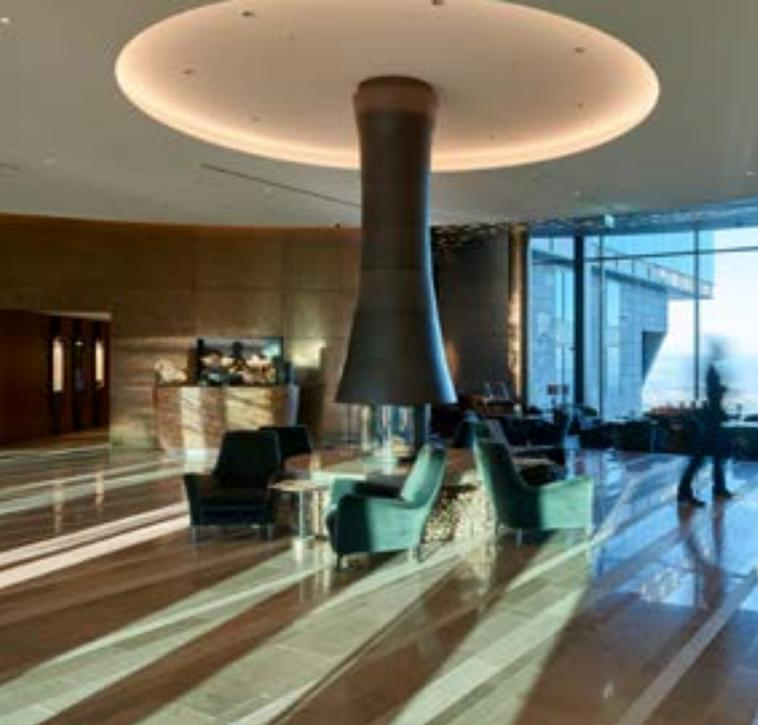
**Abb. oben:** In der Lobby tragen »Laser«-Downlights die tageslichthelle Stimmung weiter. Am Abend zeigt sich die Allgemeinbeleuchtung stufenweise gedämpfter und in der Bar wird die Helligkeit der Raumgrenzen so stark abgesenkt, dass jedwede Spiegelung in den Panoramasscheiben vermieden wird.
