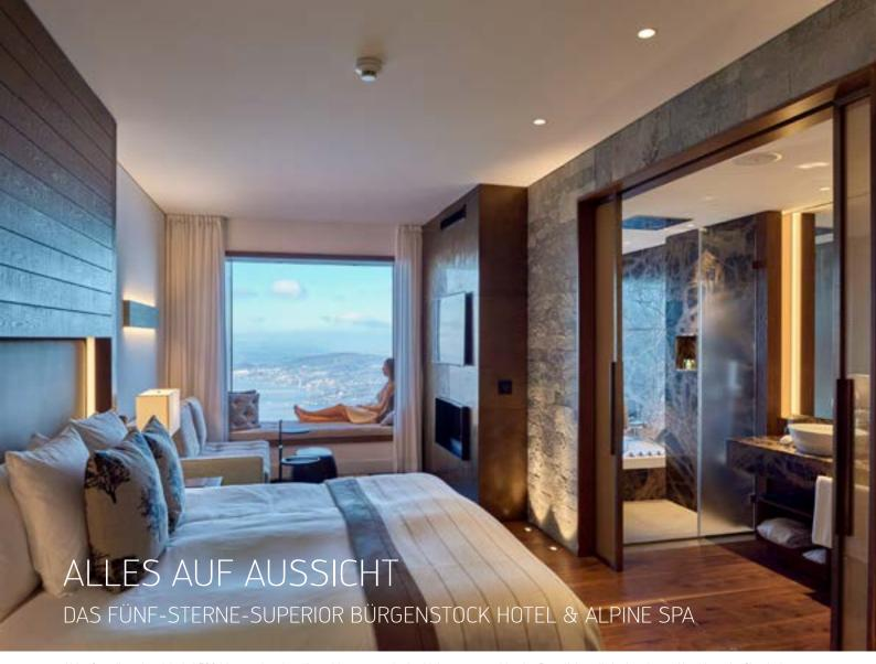
Abb.: Grandiose Aussicht bei 500 Metern über dem Vierwaldstättersee. In den kleinen, eng strahlenden Downlights, die in den oberen Abschluss der Sitznische am Panorama-Fenster integriert wurden, sind die Lichtquellen so weit zurückversetzt, dass keine störenden Spiegelungen auftreten.
