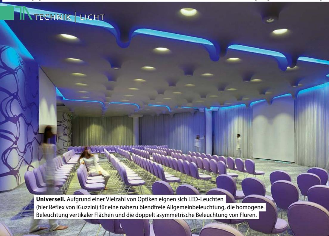
**Universell.** Aufgrund einer Vielzahl von Optiken eignen sich LED-Leuchten (hier Reflex von iGuzzini) für eine nahezu blendfreie Allgemeinbeleuchtung, die homogene Beleuchtung vertikaler Flächen und die doppelt asymmetrische Beleuchtung von Fluren.
