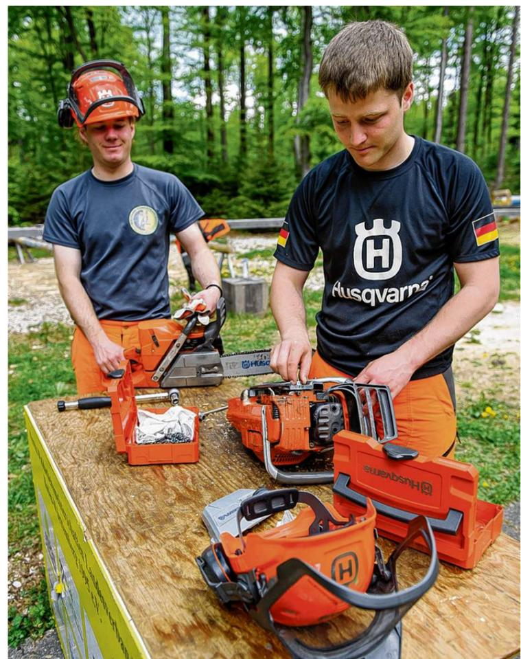
Nichts für Grobmotoriker: In der Disziplin Kettenwechsel muss der Wettbewerber nicht nur eine neue Kette aufziehen und das Sägenschwert wenden, sondern die Kette auch präzise spannen, denn für die nächsten Stationen darf er die Spannung nicht mehr korrigieren. Weitere Bilder und ein Video gibt's unter [www.hz-online.de](http://www.hz-online.de)
