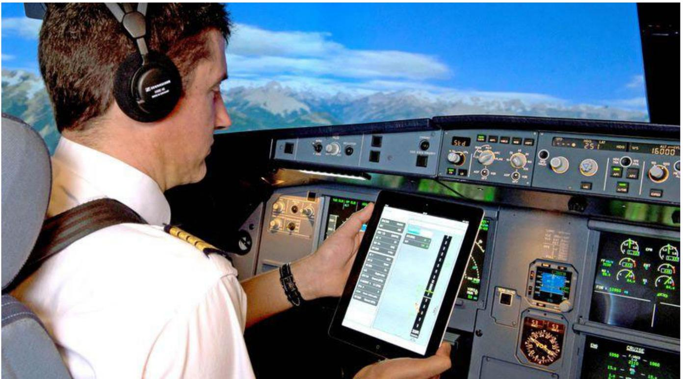
Tablet-PCs lösen schwere Pilotenkoffer ab. Wichtige Informationen wie Flugrouten werden per App abgerufen. Airbus entwickelte bereits 2012 ein "Electronic Flight Bag" auf iPad-Basis. © Airbus
