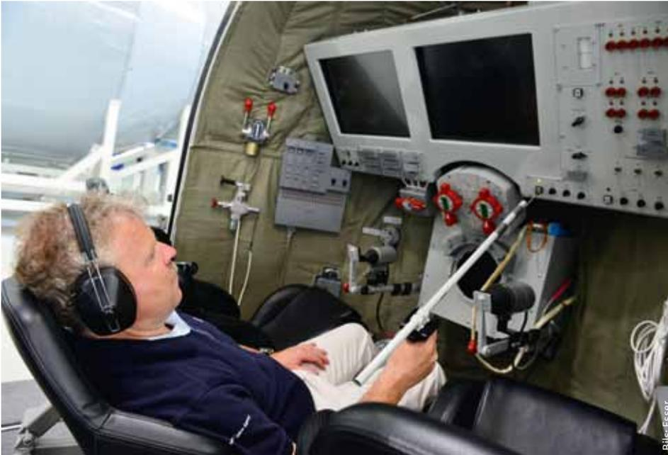
◀ In der Trainingskapsel des Sojusraumschiffs: In der Hand hält der Astronaut ein Hilfsmittel, um die Schalter zu bedienen, auch wenn man in der Konturliege angeschnallt ist.
