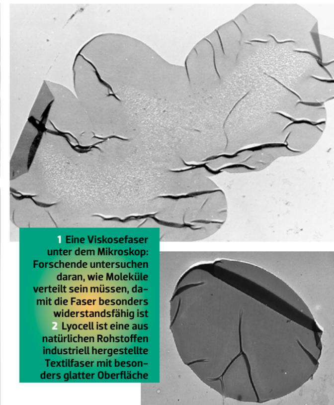
1 Eine Viskosefaser unter dem Mikroskop: Forschende untersuchen daran, wie Moleküle verteilt sein müssen, damit die Faser besonders widerstandsfähig ist
