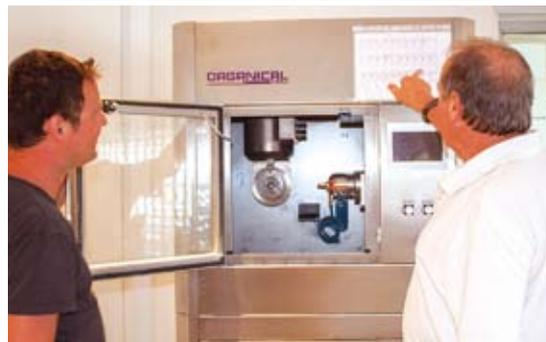
Abb. 4 und 5: ZTM Marco Köllmer und ZT Joseph Kleeblatt haben den Schritt gewagt. Das Fräszentrum Organical CAD/CAM SA befindet sich seit Februar 2014 in den Laborräumen von Joseph Kleeblatt in Kapstadt. Mit der Fünf-Achs-Fräsmaschine Organical Multi können fast alle Materialien für prothetischen Zahnersatz gefräst werden.
