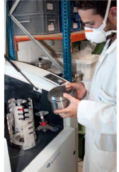
Die reine Glaskeramik wird mit mineralischen Pigmenten versetzt und homogen vermischt. Je nach Anwendung und Korngröße erfolgt dies über verschiedene Verfahren (Luftstrahlmühle, Planetenmühlen et cetera)
