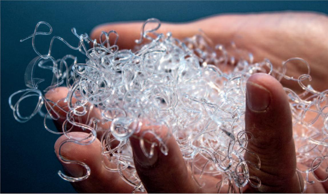
Ein Blick auf die Glasritten (Zwischenprodukt bei Herstellung von Glas- oder Keramikschnmelzen) zeigt, dass bereits der reine Rohstoff von ceraMotion opaleszente Eigenschaften hat. Ohne Zugabe von blauen oder orangefarbenen Farbstoffen ist die Opaleszenz gegeben. Der Grund sind die Mikrokristalle, durch die der blaue Anteil des Tageslichts spezifisch gestreut wird
