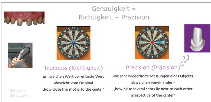
Abb. 5 und 6: „Genauigkeit“ setzt sich aus „Richtigkeit“ und „Präzision“ zusammen.
