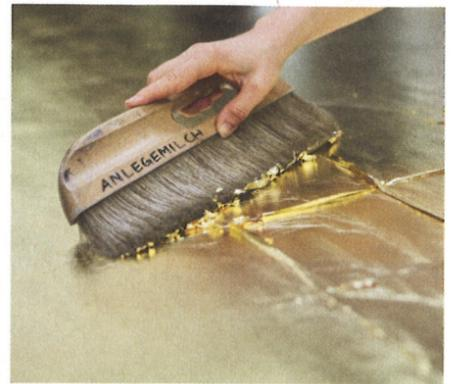
Handarbeit in der Manufaktur: Schicht für Schicht wird Blattgold auf eine Tapete aufgetragen und glatt gestrichen. Anschließend werden mit der Metallschablone Muster aus verschiedenen hellen Farbtönen zusammengesetzt
