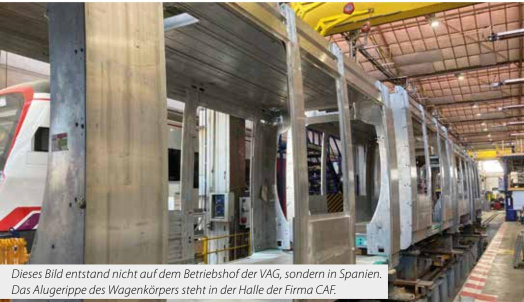
*Dieses Bild entstand nicht auf dem Betriebshof der VAG, sondern in Spanien. Das Alugerippe des Wagenkörpers steht in der Halle der Firma CAF.*
