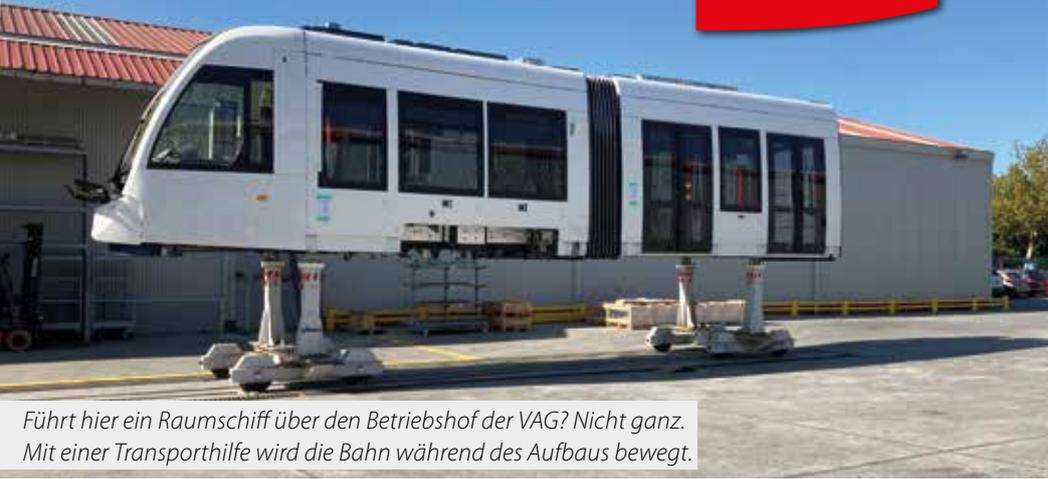
*Führt hier ein Raumschiff über den Betriebshof der VAG? Nicht ganz. Mit einer Transporthilfe wird die Bahn während des Aufbaus bewegt.*
