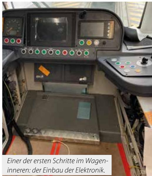
*Einer der ersten Schritte im Wageninneren: der Einbau der Elektronik.*
